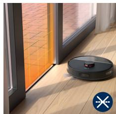
Vytvorte virtuálne steny a zóny so zákazom vstupu v oblastiach, kam nechcete robota pustiť. Môžete napríklad vytvoriť virtuálne steny a zóny so zákazom vstupu s cieľom:
