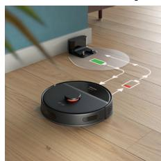
Quando la batteria si scarica (<20%) durante la pulizia, il robot torna automaticamente alla stazione per ricaricarsi. Completata la ricarica della batteria, il robot riprende la pulizia da dove si era interrotto.
