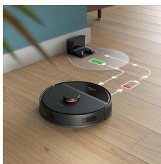
Коли батарея розрядиться (<20 %), робот автоматично повернеться на станцію для заряджання. Коли батарея зарядиться, робот продовжить роботу з того місця, де він зупинився.
