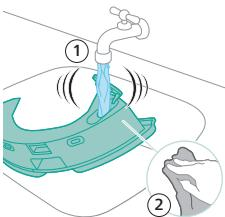
**4** Vandens bakelį išskalaukite vandentiekio vandeniu.
