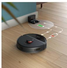
Atunci când nivelul bateriei se reduce (<20%) în timpul curățării, robotul revine automat la stație pentru a se reîncărca. După încărcarea bateriei, robotul reia procesul de unde l-a întrerupt.
