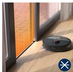
Napravite virtuelne zidove i zabranjene zone za područja na koja ne želite da robot ide. Na primer, možete da napravite virtuelne zidove ili zabranjene zone:
