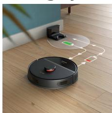
Cuando la batería está baja (<20 %) durante la limpieza, el robot regresa automáticamente a la base para recargarse. Después de cargar la batería, el robot continuará donde lo dejó.
