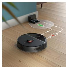
Wenn der Akku fast leer ist (<20 %), während der Roboter reinigt, fährt er automatisch zur Station zurück, um sich wieder aufzuladen. Nach dem Aufladen des Akkus fährt der Roboter mit der Reinigung fort, wo er aufgehört hat.
