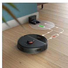
Ha az akkumulátor töltöttségi szintje alacsony (<20%) lesz takarítás közben, a robotporszívó automatikusan visszatér az állomásra töltődni. Az akkumulátor feltöltése után a robotporszívó ott folytatja, ahol abbahagyta.
