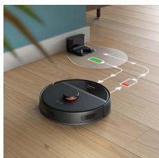
Når batteriet bliver lavt (< 20 %) under rengøring, vender robotten automatisk tilbage til stationen for at genoplade. Efter at batteriet er blevet opladt, fortsætter robotten, hvor den slap.
