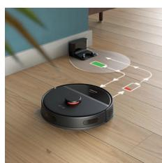
Když se během čištění vybije baterie (< 20 %), robot se automaticky vrátí do stanice, aby se dobil. Po nabití baterie robot pokračuje tam, kde skončil.
