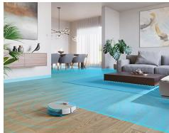
De robot rijdt door de kamers en de lasernavigatie scant snel de kamers om een plattegrond
