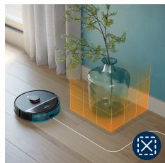
**i** Opmerking: de robot kan vastlopen in hoogpolig tapijt, vloerbedekking met rafelranden of zeer lichte kleedjes, zoals in de badkamer. De robot kan ook geen snoeren op de vloer detecteren.
