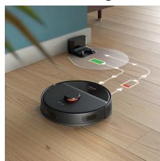
Gdy akumulator jest bliski rozładowania (<20%) podczas czyszczenia, robot automatycznie powraca do stacji w celu naładowania. Po naładowaniu akumulatora robot kontynuuje pracę w miejscu, w którym przerwał.
