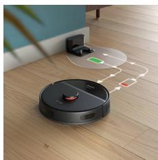
Quando a bateria fica fraca (<20%) durante a limpeza, o robot regressa à base automaticamente para carregar. Quando a bateria estiver carregada, o robot continuará no ponto em que parou.
