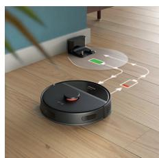
Kad tīrīšanas laikā akumulators izlādējas (<20%), robots automātiski atgriežas stacijā, lai uzlādētos. Pēc tam kad akumulators ir uzlādēts, robots turpina darbu no vietas, kur tika pārtraukta tā darbība.
