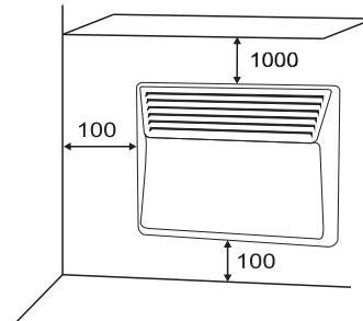
Дотримуйтесь мінімальних відстаней установки від підлоги, поверхонь меблів і т.д. (Розміри в мм).
