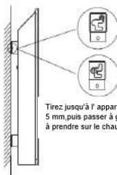
Retirez le radiateur du mur
