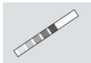
Тестер для определения степени жесткости воды
